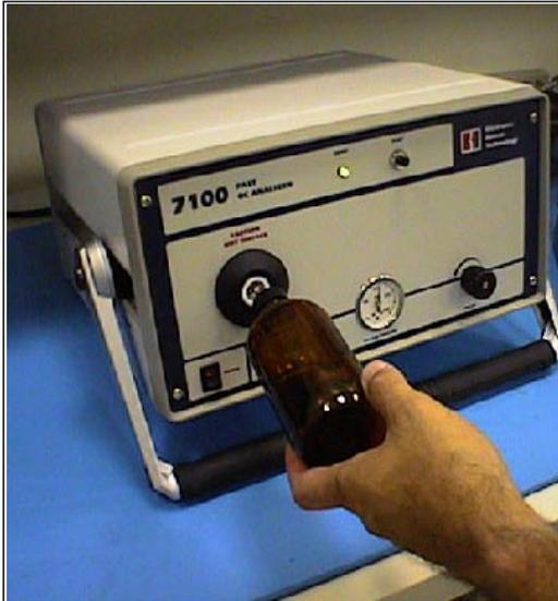
zNoseは食品の品質管理に欠くことのできない分析システムです。右図の『EST Model 7100 デスクトップ・タイプ』では、濃縮装置、ヘリウム・ボンベ、その他、コンピュータ以外の全ての装置をこの小型ケースに詰め込みました。ヘリウム一回の充填で300回の測定が可能です。
